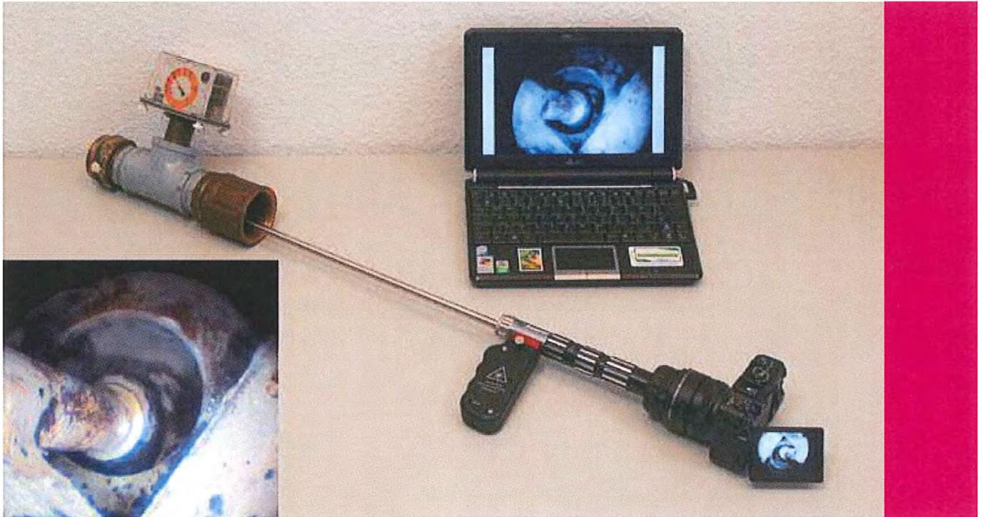
Das Set besteht aus einem Endoskop, einer Kamera (Canon G Serie), einem LED Hochleistungshandgriff und allen erforderlichen Adaptionen. Es ermöglicht die Visualisierung auf dem Kameramonitor, das Vergrößern, Speichern und Bearbeiten des Bildes. Auch Aufnahmen von Videoclips können durchgeführt werden. Durch den LED Hochleistungshandgriff wird ein komplett netzunabhängiger Betrieb des Systems gewährleistet.
